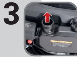
**3** Tank mit einer Benzinpumpe entleeren
