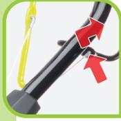
**Zugkabel des Selbstantriebs am schwarzen Bügel einhängen**
