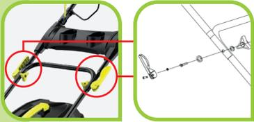
**Oberholm mit Schnellverschluss gemäss Abbildung montieren**
