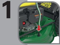
**1** Wasserschlauch anschliessen,
