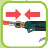
Schlauch an Bediengriff festschrauben (Linksgewinde).
