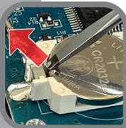
Pins sorgfältig mit einem Schlitzschraubenzieher aufbiegen
