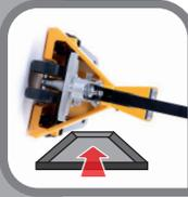
Ölwanne unter die Hydraulik positionieren
