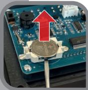
Knopfbatterie mit einem Schraubenzieher heraushebeln
