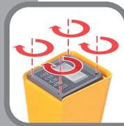
Schrauben einsetzen und von Hand festziehen
