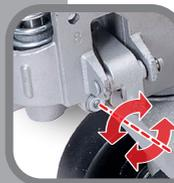
Max. Systemdruck einstellen: 2t-geeichtes Gewicht anheben. Falls das Gewicht nicht gehalten werden kann, die Schraube anziehen. Schraube nicht mehr als nötig festziehen! Bei zu fest angezogener Schraube besteht Gefahr, dass die Hydraulik durch Überlastung beschädigt wird
