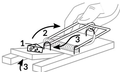
Köder im Köderbügel fixieren Überbügel nach hinten legen, Schlagbügel um 180° vorspannen, Überbügel über gespannten Schlagbügel an Wippe arretieren. **Achtung – beim Spannen der Falle auf keinen Fall in den Wirkbereich des Schlagbügels fassen!**
