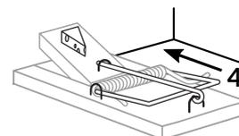
Beköderte, gespannte Falle mit der Wippe zur Wand entlang üblicher Laufwege aufstellen und regelmäßig kontrollieren. Räume und Bereiche mit gespannten Fallen kennzeichnen und absperren!
