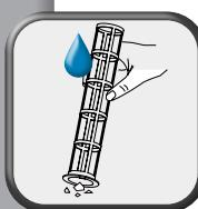
Schmutz und Fremdkörper entfernen und mit Wasser ausspülen
