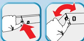
Bei Bedarf, Winkel Taste drücken und Neigung der Bürsteinheit verändern
