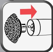
Bürstkopf auf die Bürsteinheit aufschieben
