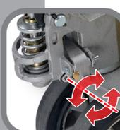
Max. Systemdruck einstellen: 2.5t-geeichtes Gewicht anheben. Falls das Gewicht nicht gehalten werden kann, die Schraube anziehen. Schraube nicht mehr als nötig festziehen! Bei zu fest angezogener Schraube besteht Gefahr, dass die Hydraulik durch Überlastung beschädigt wird
