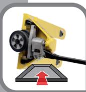
Ölwanne unter die Hydraulik positionieren
