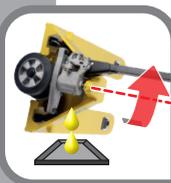
Deichsel nach oben drehen und Öl vollständig entleeren
