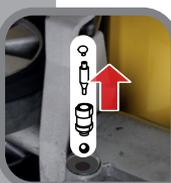
Ventil entnehmen, reinigen und auf Beschädigung prüfen.
