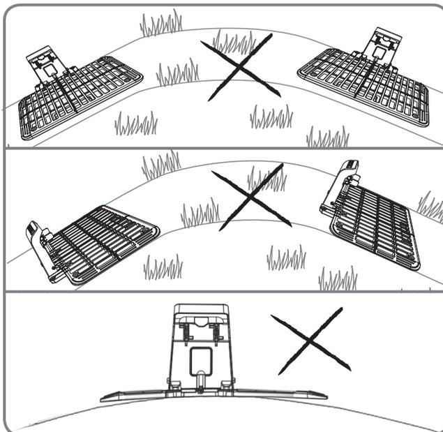
Die Ladestation muss auf einem relativ ebenem Untergrund aufgestellt werden. Diese darf nicht auf einer geneigten Fläche oder an einem Ort positioniert werden, der die Platte biegt.
