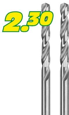
Pour acier allié et non allié, fonte grise, métaux NF, plastiques durs. Coupe à droite, type N, laminé, revenu à la vapeur, angle aigu 118°. Matériau : HSS. Norme : DIN 338.
