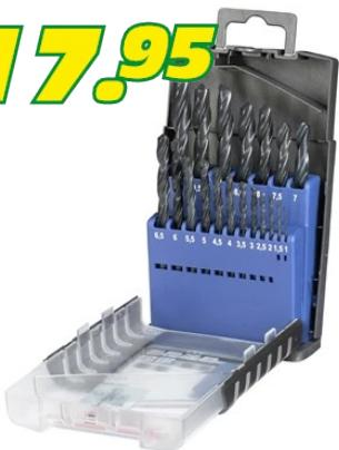
Pour acier, fonte grise, métaux NF, plastiques durs. Coupe à droite, type N, laminé, revenu à la vapeur, angle aigu 118°. Matériau : HSS. Norme : DIN 338.
