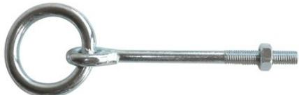
En acier. Galvanisé brillant. Avec filetage métallique. Épaisseur du matériau 10 mm. Ø intérieur (anneau) 45 mm. Ø extérieur 59 mm. Vis Ø 10 mm, longueur de vis 75 mm.
