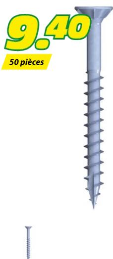
Tête plate conique. Galvanisée, passivée bleu. Filetage partiel. Entraînement : Torx. Norme : RN 9251. Dimensions : 4,5 x 60 mm.
