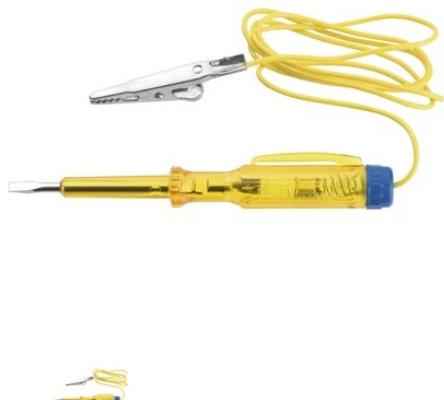
Pour les tests de courant faible. Laiton avec câble fixe, pince crocodile et pointe.
