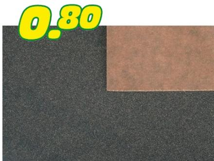
Pour le ponçage à l'eau des métaux. Matériau : papier support en latex saupoudré électrostatiquement de carbure de silicium. Épaisseur : K120.
