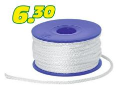
Corde universelle PE et indéformable. Longueur : 20 m. Diamètre : Ø 3,5 mm. Bonne résistance aux UV. Charge utile max. : 30 kg. Charge de rupture : 150 kg. Fabriquée en Suisse.
