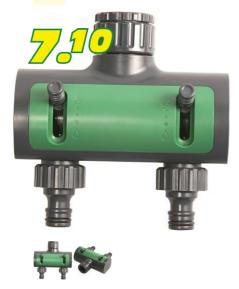
Raccord jusqu'à 2 raccords de tuyau au robinet d'eau F 1/2" (21 mm) / F 3/4" (26,5 mm). Réglage du débit d'eau en continu 0 – 100 %. Pression d'eau max. : 8 bar. Matériau : plastique.
