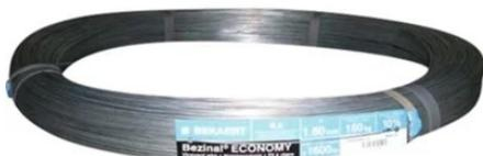
Matériau spécial pour la viticulture, présentant une résistance élevée à la corrosion. Avec un diamètre de 2 mm, une charge de rupture de 250 kg et une résistance à la traction élevée, c'est un excellent choix pour l'utilisation dans les vignobles.
