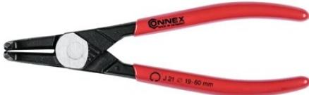
Pour bagues intérieures (alésages) 19 - 60 mm Ø. Avec pointes cylindriques. Matériau : Acier au chrome-vanadium. Traitement de surface : forgé, entièrement trempé, poli.
