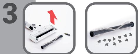
Bürste entnehmen und reinigen
