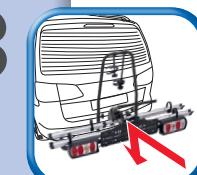
Fahrradträger auf Kupplung aufsetzen
