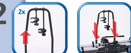
Befestigungsarmen in den Rahmen einführen, Rahmen einsetzen
