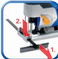
Anschlag und Sägeblatt entfernen
