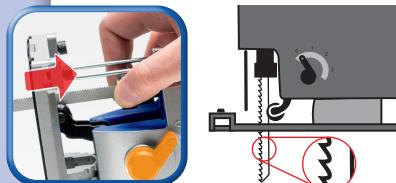
Sägeblatt bis zum Anschlag einschieben
