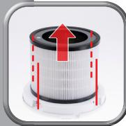
Gehäuse von der Basis entfernen
