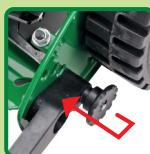
Federbolzen herausziehen und in gewünschter Position einrasten lassen.
