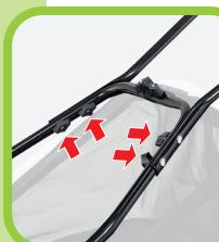
Den unteren Teil des Schubbügels am oberen Teil montieren.
