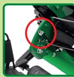
Gegenmesserposition durch einstellen der beiden Stellmuttern optimieren.
