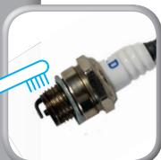
Rückstände mit Drahtbürste reinigen
