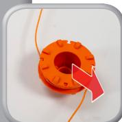
Fadenspule entfernen, entsorgen
