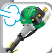
Gerät mit Druckluft (niedriger Druck) ausblasen
