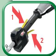
**Gashebel-Entriegelung und Gashebel gleichzeitig drücken**
