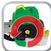
Filterabdeckung korrekt anbringen
