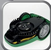
Roboter umkehren, gegebenenfalls eingeklemmte Gegenstände entfernen
