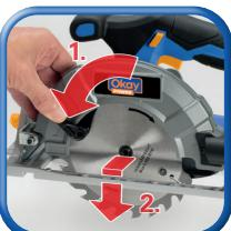
Kreissägeblatt lösen, entnehmen
