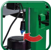
Gerät ausstecken, Netzanschluss trennen
