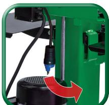
Stromkabel einstecken, Netzanschluss herstellen
