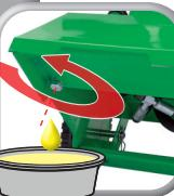
Schraube lösen, Oel vollständig ablaufen lassen
