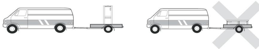
L'appareil doit toujours être stocké et transporté en position verticale sur une palette et dans l'emballage d'origine. Si l'appareil est entreposé ou transporté en position horizontale, attendez au moins 24 heures avant de le brancher.
