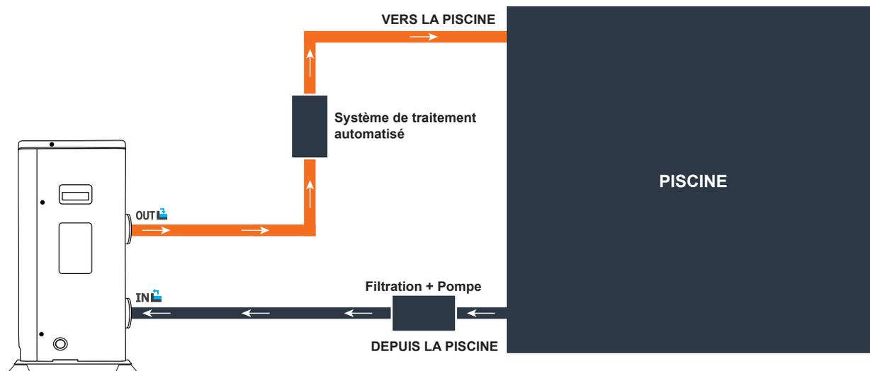
Le filtre situé en amont de la pompe à chaleur doit être nettoyé régulièrement pour que l'eau du circuit soit propre et ainsi éviter les problèmes de fonctionnement liés à la saleté ou au colmatage du filtre.
