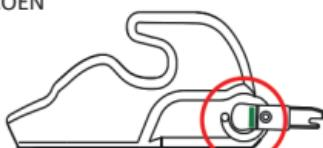
Laat de behuizing los zodat de haken vastklikken. Het controlevenster wordt groen.
