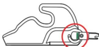
Lassen Sie das Gehäuse los, sodass die Haken einrasten. Das Kontrollfenster wird grün.
