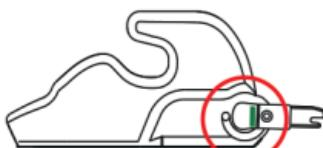
Lâchez le logement pour que les crochets s'encliquettent. La fenêtre de contrôle devient verte.
