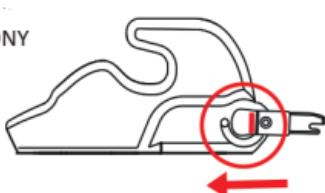
Aby otworzyć haki, odciągnąć czarną obudowę zaczepu Isofix do tyłu.
