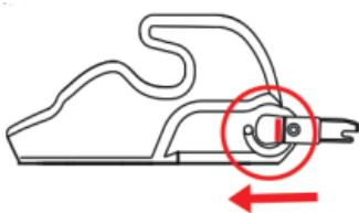
Ziehen Sie das schwarze Gehäuse der Isofix-Halterung nach hinten, um die Haken zu öffnen.
