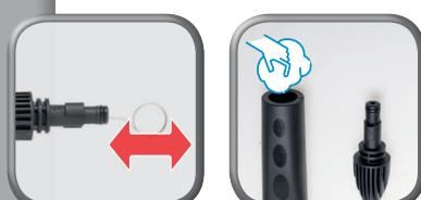
Ventile mit Draht und feuchtem Tuch reinigen
