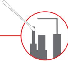
Bei Verschmutzung: Thermosicherung vorsichtig reinigen
