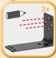
Löcher für Wandhalterung anzeichnen/bohren, Löcher ausblasen, Dübel setzen
