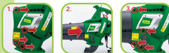
Schrauben und Muttern lösen, Blas-/Saugrohr in Motorgehäuse stecken, fixieren
