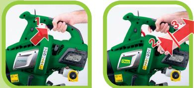
1. Gerät mit rechter Hand gut fixieren, gleichzeitig Gashebel drücken
