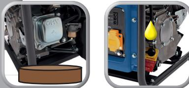
**Motorenöl ablassen,** neues Öl einfüllen (S.20)
