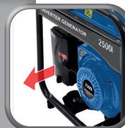
Luftfiltergehäuse lösen/ abheben
