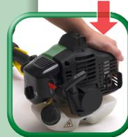
Gerät mit linker Hand gut fixieren
