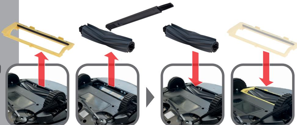
Gummibürste entnehmen und reinigen
