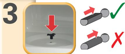
Halterung für Drehteller einsetzen
