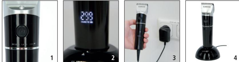
För att tända LED-lampen måste du trycka och hålla in strömbrytaren i minst 3 sekunder. Om du återigen trycker på strömbrytaren i 3 sekunder, släcks LED-lampen. LED-displayen visar återstående klipptid i minuter (bild 2). När klippmaskinen är avstängd visar LED-displayen klipptiden i sekunder.
