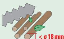
**Max. Schneidradiusmesser:** abhängig von Typ, Alter, Feuchtigkeits- und Härtegrad des Holzes
