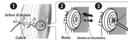
Les vis et les rondelles sont préinstallées sur l'arbre. Veuillez vérifier si les accessoires sont complets : Roue: 2 pièces
