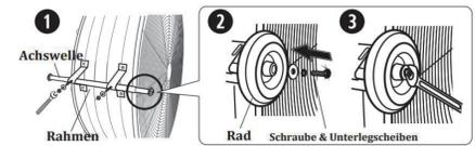
Die Schrauben und Unterlegscheiben sind auf der Welle vormontiert. Bitte prüfen Sie, ob das Zubehör vollständig ist:
