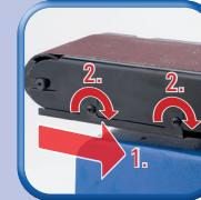
Abdeckung aufsetzen, Schrauben anziehen
