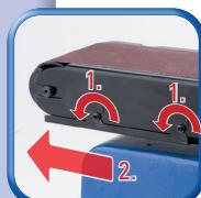
Schraube anlösen, Abdeckung entfernen
