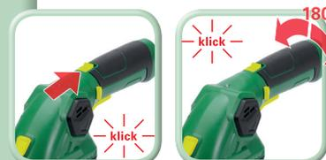
Bei Bedarf, Taste zurückziehen und Messerkopf drehen
