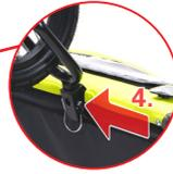
Sicherheitsstift und Deichsel entfernen. Vorderrad in die Frontstange stecken.
