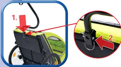
Deichsel in die Frontstange stecken. Mit Sicherungsstift sichern.
