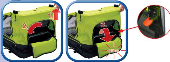
Anhängerdach hochschieben. Reisverschluss öffnen und Verstrebung nach hinten klappen.
