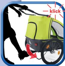
**Parkieren:** Feststellbremse bis zum einrasten mit dem Fuss nach unten drücken.
