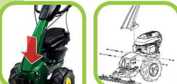
Armgehäuse aufsetzen, beidseitig festschrauben
