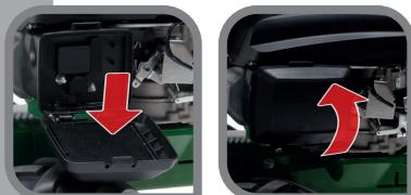
Luftfilter einsetzen, Luftfiltergehäuse
