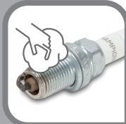
Rückstände mit Drahtbürste reinigen
