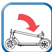
Verriegelung lösen, Lenkermast abklappen
