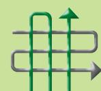
! Arbeitsrichtung wenn möglich immer quer zu Hängen. Gerät nicht an steilen Hanglagen (> 10°) einsetzen.
