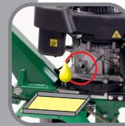
Schraube lösen, Bodenhacke kippen
