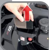
Luftfilter herausnehmen und reinigen
