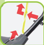
Zugkabel der Motorbremse durch die Öffnung im Getränkehälter fädeln und am gelben Bügel einhängen
