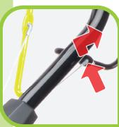
Zugkabel des Selbstantriebs am schwarzen Bügel einhängen
