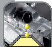
Öl-Deckel öffnen und Öl vollständig ablaufen lassen
