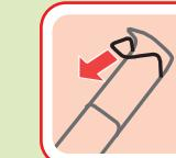
**Notfall-Ausschaltung:** Bei Gefahren, Unfällen, stark vibrierendem Gerät sofort Motorbremshebel loslassen.
