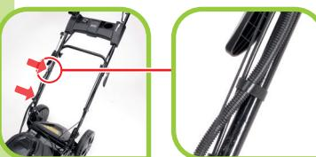
Kabelkanal mit Velcro am Holm fixieren
