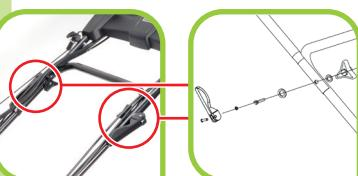
Oberholm mit Schnellverschluss gemäss Abbildung montieren
