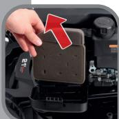
Luftfilter herausnehmen und reinigen
