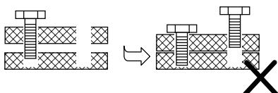
Ziehen Sie Schrauben und Muttern erst dann vollständig an, wenn alle Schrauben montiert sind.
