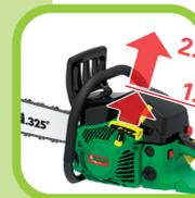
Starterseil bis zum Widerstand spannen, dann ruckartig ziehen. Wiederholen bis der Motor startet
