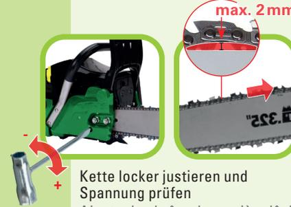
Kette locker justieren und Spannung prüfen
