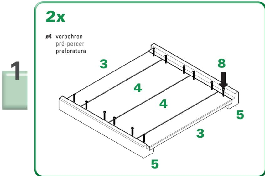
Elemente (3/4/5) mit Schrauben (8) zu zwei Kopfteilen zusammenschrauben.
