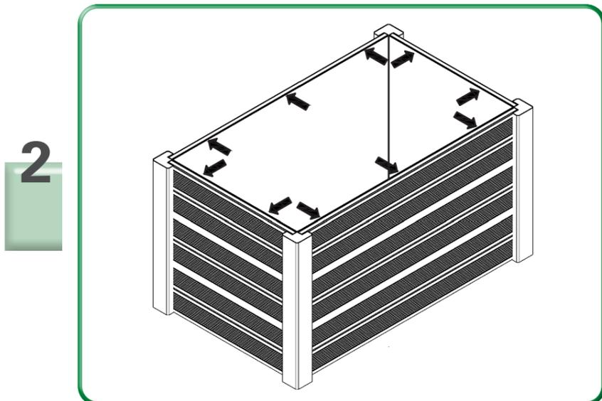
Vlies (9) einlegen und oben und unten mit Klammern befestigen.
