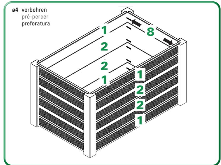
Beide Kopfteile mit den Elementen (1/2) zu einem Kasten zusammenschrauben (8).
